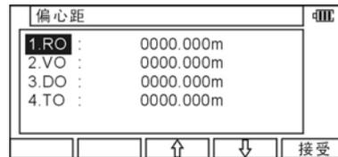
按[ENT]进入偏心输入窗口，按输入键输入 RO 偏心值。VO, DO 和 TO 的输入也可同样处理。
