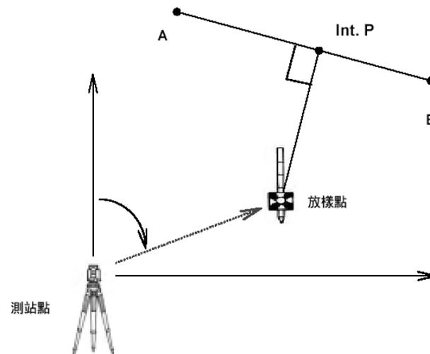
你必须选择至少相距 1 米的两点 A 和 B，用这两点定义一条直线，放样过程中，放样点到直线的距离会显示在放样屏幕中。
