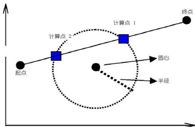
用于计算直线与圆的两个交点。直线是由SP（起点）与EP（终点）所确定,而圆由CP（圆心）和R（圆的半径）确定。你可以存储两个计算出来的交点的坐标。
