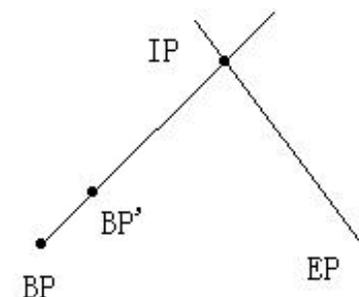
基本桩间距的初始值为 20 米，曲线段桩距的初始值为 5 米。两者的输入范围是 1 到 100 米。
