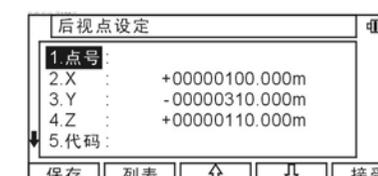
按[ENT]键显示“放样坐标设定”界面，打开点号 X Y Z 镜高 代码输入窗口，并输入各值。
