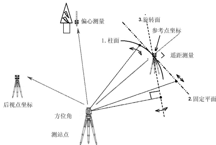
测量人员可以由测站点坐标和后视点坐标测出前视点坐标, 或由方位角及测站点坐标测出前视点坐标, 并将点名及其坐标信息存储。当站点坐标及后视点坐标预先存入内存, 则无需输入这些坐标, 只要从点名列表中搜索即可。点名在 15 个字符内, 坐标为 8 位整数, 3 位小数。有直角坐标和极坐标两个坐标类型。在测量中目标点的偏心测量和遥距测量只可在直角坐标系下进行。
