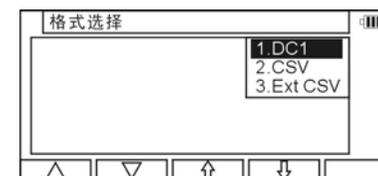
选择DC1格式并按[ENT]显示“数据发送确定”界面。（对CSV方法相同）。按[ENT]，并使电脑准备好接受。
