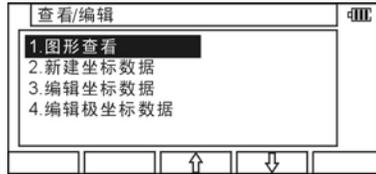
选择“1.图形查看”，按[ENT]可以图形显示存储的点。点、点名及其图形被显示，可以按箭头任意方向移动图形。
