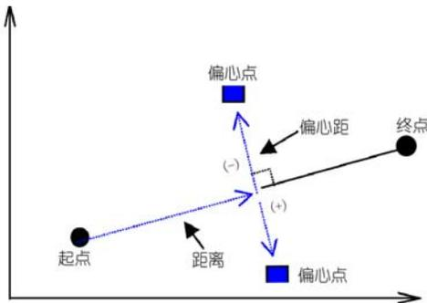
通过输入垂足点到起点的距离和偏心点到直线的距离计算出偏心点的坐标。
