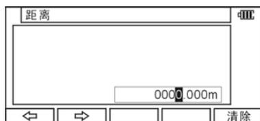
输入你要的值，按[ENT]打开水平角输入窗口。
