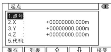
输入起点的点号，X，Y，Z和代码，或从[F2][列表]中选择已存储的点作为起点。
