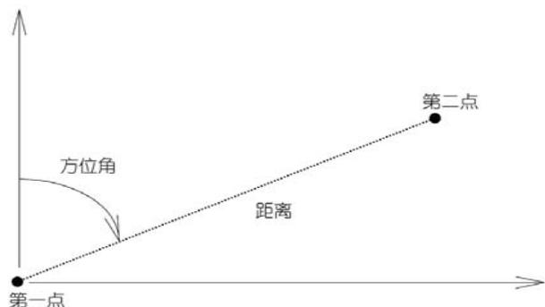
通过未知点与一个已知坐标点的距离和方位角可以计算出未知点的坐标。
