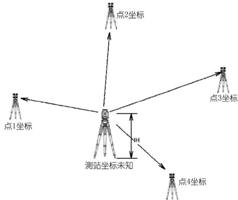
测站点坐标由多个已知点计算而得，要获得坐标，至少必须两个水平角，一个距离或三个水平角，否则就会显示“计算出错”屏幕，提示“没有足够的数据用来计算”！至少需要2个角和1个距离或至少需要3个角”。进入该功能首先是仪高输入界面，先输入仪器高。
