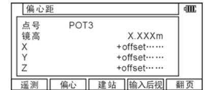
当保存测量值并进行下一个测量点的时候，你输入的偏心值就被清除了。
