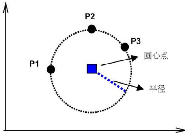
根据三个已知点可以求出圆心坐标与半径
