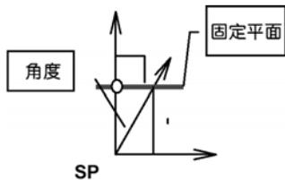
如左图所示测距测量是在垂直于对参考点的照准线的固定平面上执行的。
