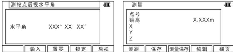
按[测距]来测量距离及显示坐标。当测距结束后：
