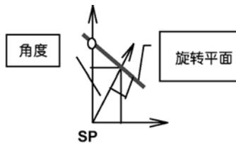
如左图所示测距测量是在旋转平面上执行的。该旋转平面垂直于当前照准线并通过参考点。
