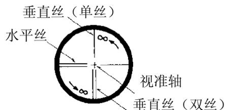
② 将望远镜对准一个明亮的目标，旋转目镜调焦环。
