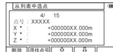
按 [ENT] 打开点号、X、Y、Z、仪高值输入窗口，输入字符与数值并按[ENT]进入“仪器点水平角设定”界面。
