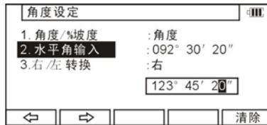
按确认键[ENT]确认将水平角设定为 123°45' 20"，转入模式 A 的显示窗口。
