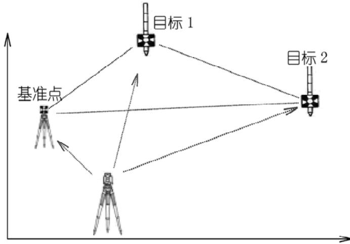
对边测量功能可量测基准点与目标点、目标点与目标点之间的平距、垂距、斜距、坡度百分比。任一目标点可被改变为新基准点。
