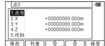
如果你完成点3的输入，按[F5][接受]，进入“三点定圆结果”屏幕。屏幕显示出三点外接圆的圆心点坐标和半径。
