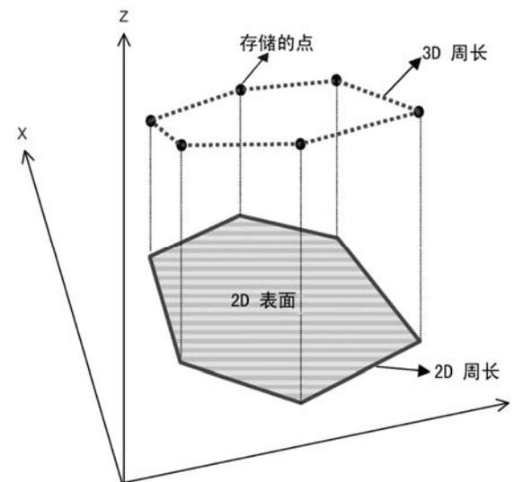
本功能计算一个多边形的2D与3D周长和多边形定义的面的2D面积（投影到水平面的面积）。
