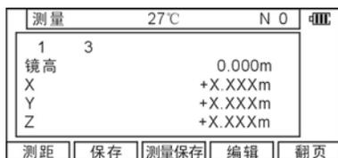
照准点1，按[F1][测距]，显示测量坐标。
