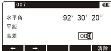
通过字符输入键在数字命令窗口内输入所需数字命令（如：按[5][0][2]将打开单次测量次数显示菜单）。
