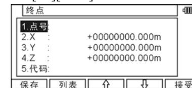
同样如输入起点那样输入终点，完成后按[F5][接受]，然后进入“圆心”输入界面。
