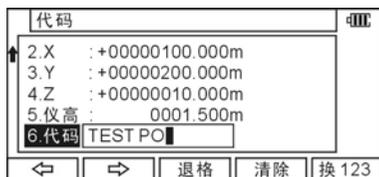
通过按键输入你确定的代码名称, 按[ENT]键进入下一个界面, 如果在“处理方法”选择了“直接进入”, 那么在输入并确认了代码后, 输入的代码数据将自动存储, 然后“测站点后视水平角”窗口将被显示。如果在“处理方法”中选择了“选择进入”, 就需要按[接受]来进入下一个界面。
