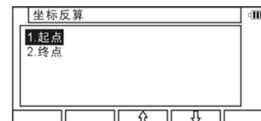
A. 输入起始点（输入起点点名，坐标，点代码）选择“1.起点”，按[ENT]显示“起点”界面。
