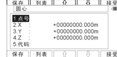
同样方法完成圆心的输入后，按[F5][接受]，进入“半径”输入界面。
