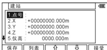
打开点号、X、Y、Z、仪高、代码输入窗口并输入各项数据，用[F1][保存]键保存数据，按[F5][接受]键显示“测站点后视水平角”界面。
