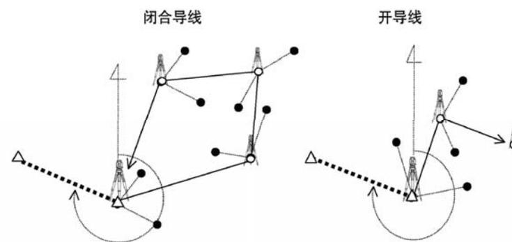
此功能可用于附和导线、闭合导线和开导线的计算。可以在导线测量的同时，进行碎步点观测。当导线测量完成时，将算出坐标闭合差并对导线点进行平差，并根据平差后的坐标计算碎步点的坐标。
