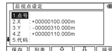
按[F2]进入输入水平角窗口。在输入水平角后按[ENT]。如果在“设定”的“6.需要照准”中选择了“1.开”则显示“照准参考点”屏幕, 如果选择了“2.关”则不出现该屏幕, 如果后视点坐标已输入, 则也会显示“照准参考点”屏幕。
