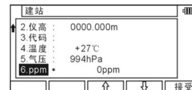
参考“4.6 建站（极坐标测量）”输入点号、仪高、代码、温度、气压和ppm。
