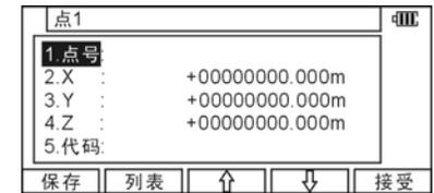
输入第一个点的点号、X、Y、Z和代码，或按[F2][列表]键，从内存中调出已有的坐标数据。在完成第一个点的输入后，按[F5][接受]，然后进入“点2”点输入界面
