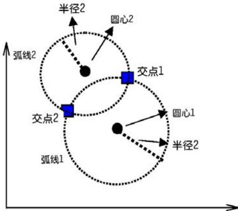
本功能是计算由圆心与半径所确定的两条弧线的两个交点
