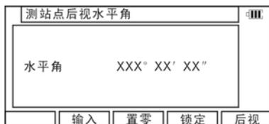
用[F2][输入]、[F3][置零]、[F4][锁定] 键输入水平角，或者按[F5][后视]输入后视点坐标。
