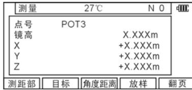
按[F1][测距部]能够选择测距部设置。例如：如想用主测量键进行连续测量，可改变“1.第一级[测量]键”为连续测量或快速连续测量。
