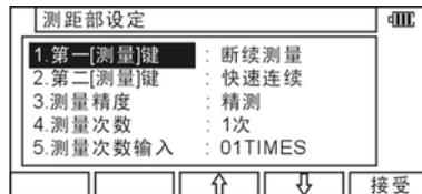
如果要用主测量键进行连续测量, 则可以改变“1.第一级[测量]键”为“连续观测”或“快速连续”。
