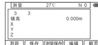
瞄准第三个点，按[F1][测距]键，显示所测量的坐标。
