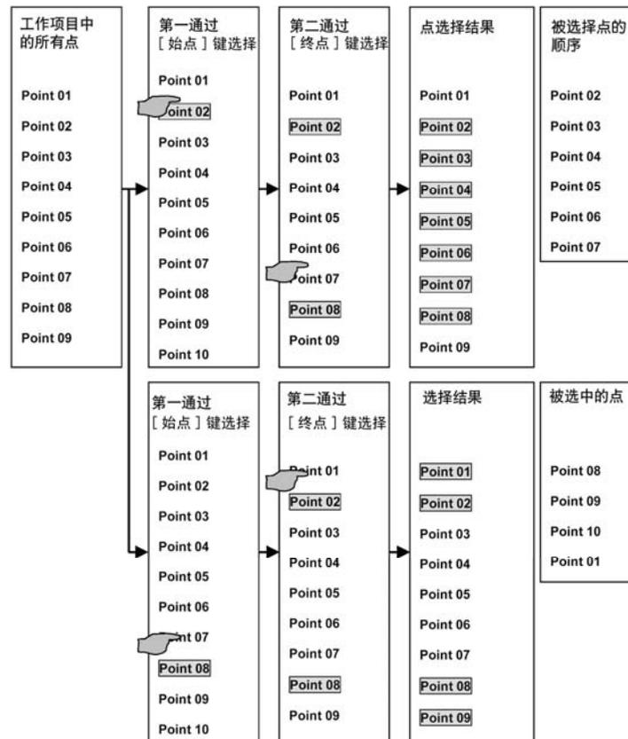
注：[F1]排序]键用于在结束选择之后查看所选点的次序。在完成多边形所有点的选择后，按[F1][接受]键进行计算，并显示计算的果。
