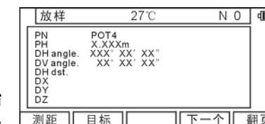
瞄准放样点，[F1][测距]开始放样，每点的差显示出来，放样的偏差显示形式可以选择“设定”设置里的“放样显示信息”来改变。
