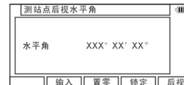
按[F2][输入]键输入水平角。[F3][置零]和[F4][锁定]，[F5][后视]显示后视点坐标。
