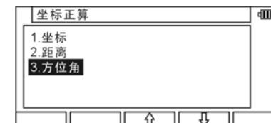
选中“3.方位角”，然后按[ENT]显示“水平角”输入界面，输入水平角。
