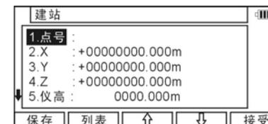
输入站点的P点号X, Y, Z和仪高。
