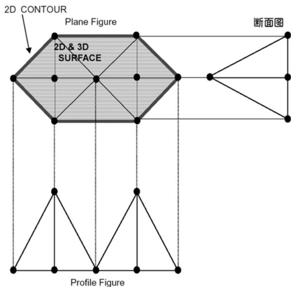
本功能计算中心，2D面积与3D表面积以及正、负方和全部体积。首先选择用于体积计算的点，对于所选点的顺序并不重要，选点的方法与 2D 表面计算方法相同，软件自动生成这些点的格网（三角形），并基于这些三角网格计算成果。
