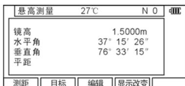
照准棱镜测量，然后按 ENT，屏幕上显示的“悬高测量”数据就是当前十字丝照准的目标点到地面的距离。（抬高或降低望远镜，其数值会相应变化）
