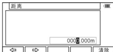
输入未知点到已知点的平距，按[ENT]键进入“水平角”输入界面。
