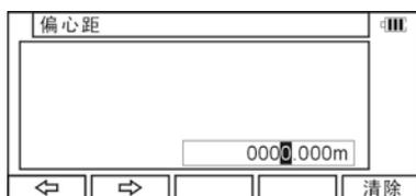
输入偏心距（偏心点到弧线的偏心距）后，按[ENT]，进入“弧线-距离偏心结果”界面。
