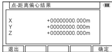
按[F5][确认]进入“坐标计算的结果”界面。在这里可编辑点号、X、Y、Z和代码，然后按[F5][接受]保存计算出来的偏心点的坐标数据。
