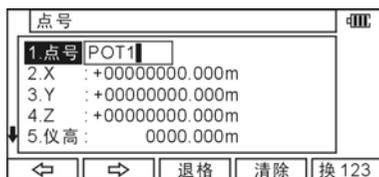
输入所定的点名，当所有字符均已输入，按[ENT]。有4种字符输入方法可供选择。[参考“13.3 输入方法选择”]
