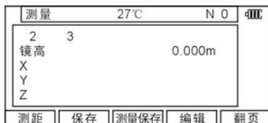
同样瞄准第二点，按[F1][测距]，测量并显示坐标。
