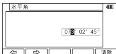
输入方位角，按[ENT]键显示“坐标计算的结果”界面。未知点的坐标便会在屏幕上显示出来。
