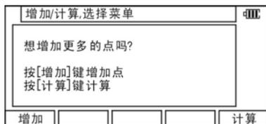
按[F1][增加]显示“已知点坐标设定”界面，用同样方法输入 2、3、4 点值，并依次照准 2、3、4 点。
