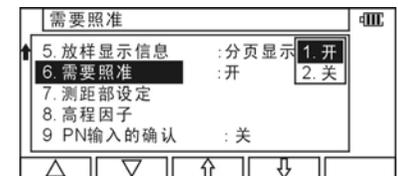
在进入后视点水平角界面后按[ENT]，当选择“开”时，显示“照准基准点”界面，而选择“关”时，则不显示该屏幕提示。
