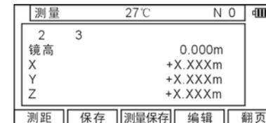
按[ENT]进入“虚平面测量”界面。此时，只要瞄准所需的点，即可获得所瞄准方向在虚平面上相应点的坐标。
