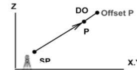
TO: 切线偏心 (TO: 在水平面上垂直于站点与被测点的水平连线, OFFSET P: 沿着坡度)
