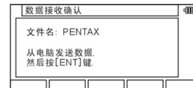
在电脑端设置好准备发送之前，先在全站仪端按[ENT]接收从电脑来的数据，接下来在电脑端按确认键开始发送数据。
