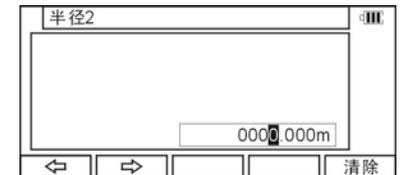
输入第二个圆的半径2值，如果你完成半径2的输入，按[F5][接受]，进入“弧线-弧线交会结果”界面。
