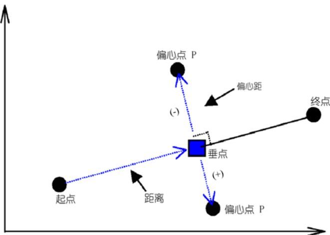
偏心点P到直线的偏心距和起点到垂点的距离被显示出来，在直
