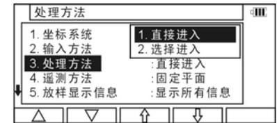
处理类型：这种输入方法采用 PowerTopoLite 的输入功能，即在输入必要项目后就进入下一屏幕。
