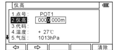
用光标键移动到代码处并按[ENT]进入点代码输入界面。
