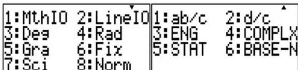
图 A-5 按 SHIFT SETUP 键的 SETUP 菜单
