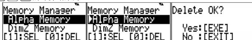
图 A-9 在 **MEMORY** 模式清除变量寄存器内容的操作过程
